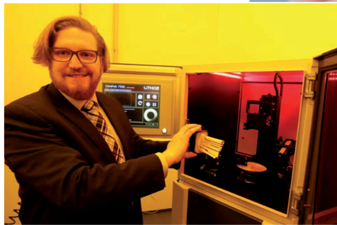
Bei der Lithoz GmbH druckt man Bauteile aus Hochleistungskeramik, wie diese Keramik-Gusskerne für Kühlkanäle in Turbinenschaukeln
