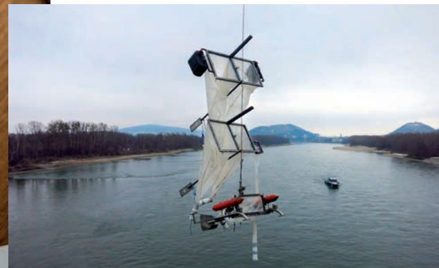
Im Umweltbundesamt wird Mikroplastik untersucht. Eine der Probeentnahmestellen lag an der Donaubrücke Hainburg. Von der BOKU entwickelte spezielle Netze wurden versenkt, um kleinste Kunststoff-Teilchen herauszufiltern
